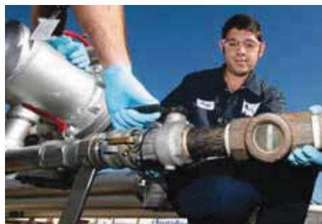
在正常脱卸操作和意外断开的事故中,真正的OPW Kamvalok®干式快换接头都能达到防止物料损失的目的。
